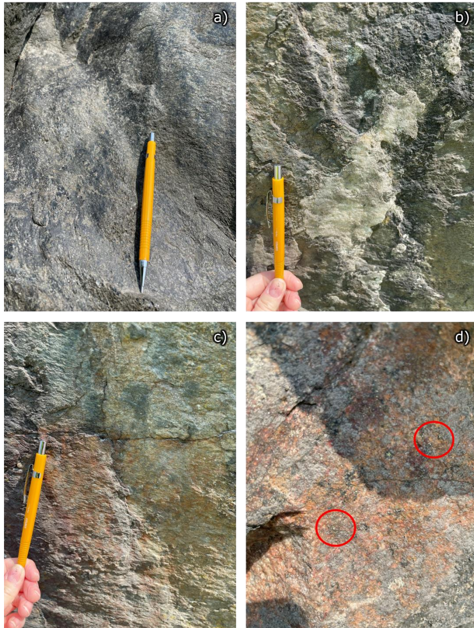
Figur 8. a) Undulerande slät sprickyta i finkornigt mörkgrått parti med kloritbeläggning. b) Vitt sprickmineral i form av kalcit. c) Kloritbeklädd spricka med järnutfällningar. d) Mycket små korn av järnsulfid i form av pyrit, inringat i rött.
